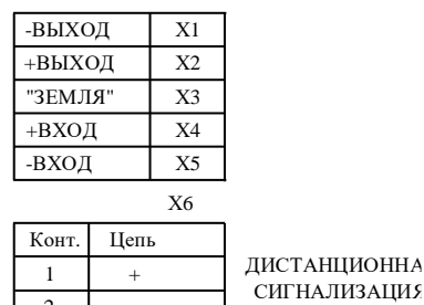
Рисунок 12.2 - Схема подключения стабилизатора СПН-3 (для самостоятельной поставки)
