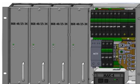
Рисунок 4.3 - Пример размещения устройств внутри панели ввода и распределения УЭПС-3К 60/80, УЭПС-3К 48/100
