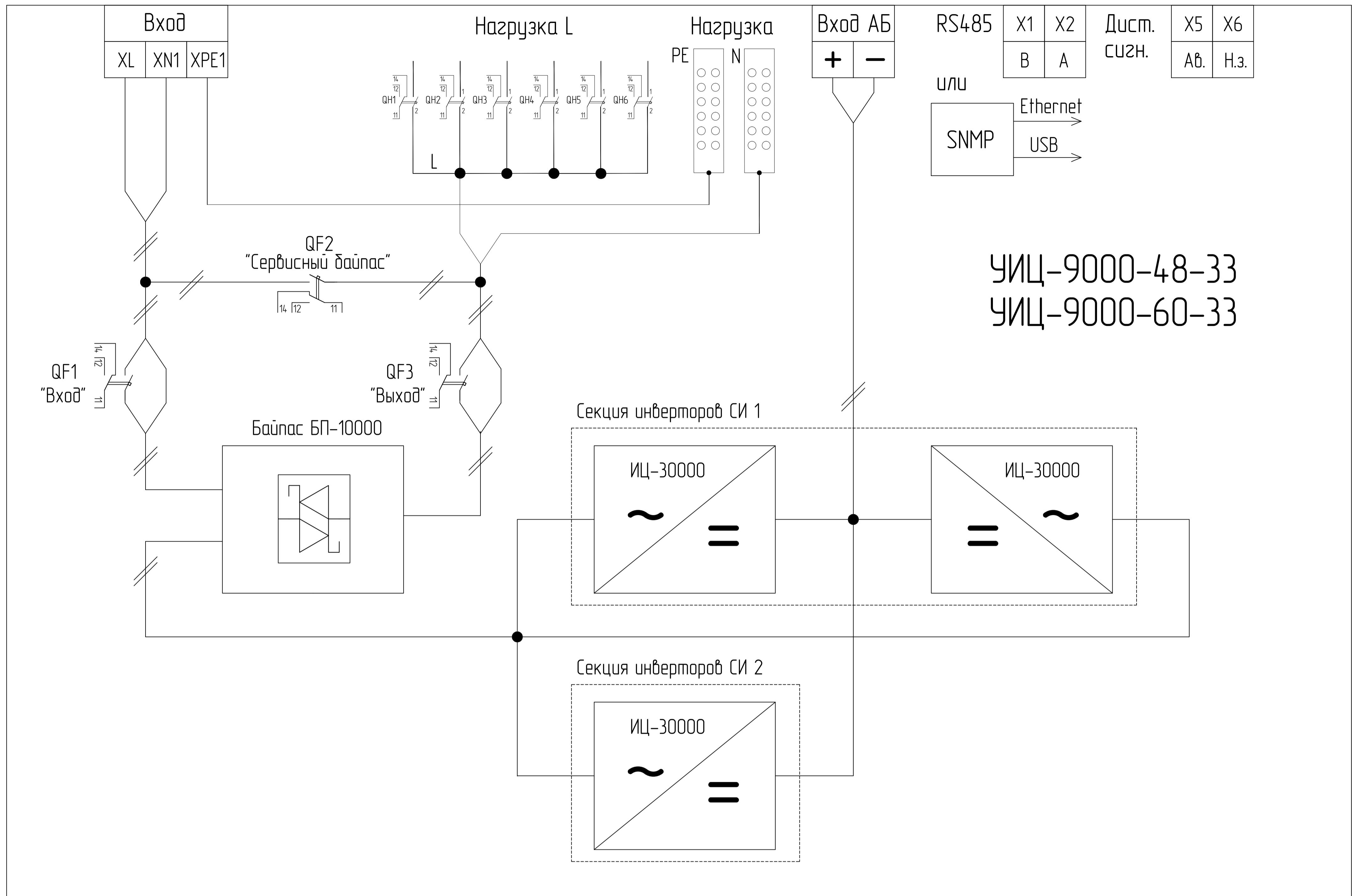
Сеть переменного тока подключается к винтовым клеммам (XL, XN1, XPE1). Максимальное сечение проводов 16 мм<sup>2</sup>.
