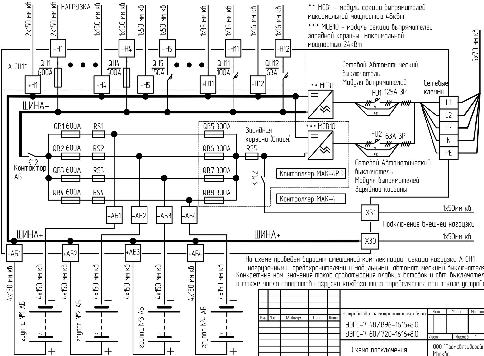
\*\* МСВ1 - модуль секции выпрямителей максимальной мощностью 48кВт
